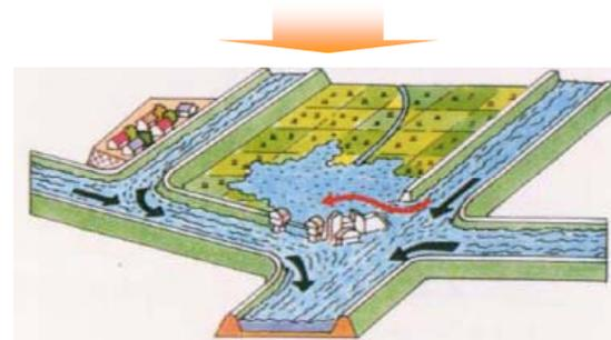
③ 大きな洪水のときは、洪水の一部を越流堤から計画的に遊水地に導き、一時的に貯留し、河川の流量を低減させる
