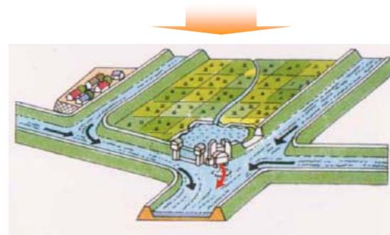
② 中小洪水の時は、遊水地内の水をポンプで吐き出し、浸水させない
